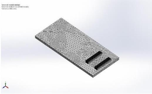
Fig. 10. Malla del modelo de simulación
