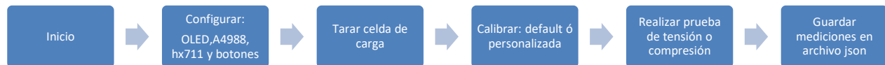
Fig. 6 Diagrama de flujo de algoritmo de control para máquina universal de pruebas.
