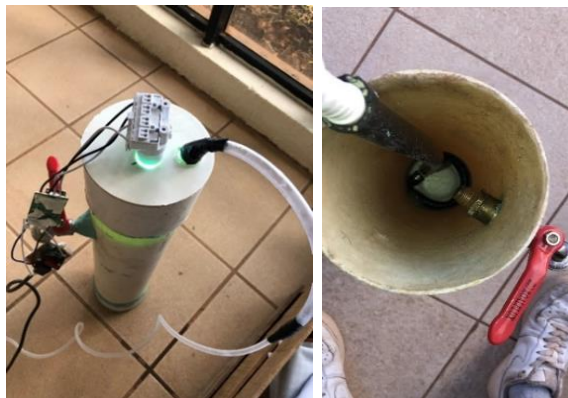
Fig. 4. Sistema de iluminación adherido al reactor.
