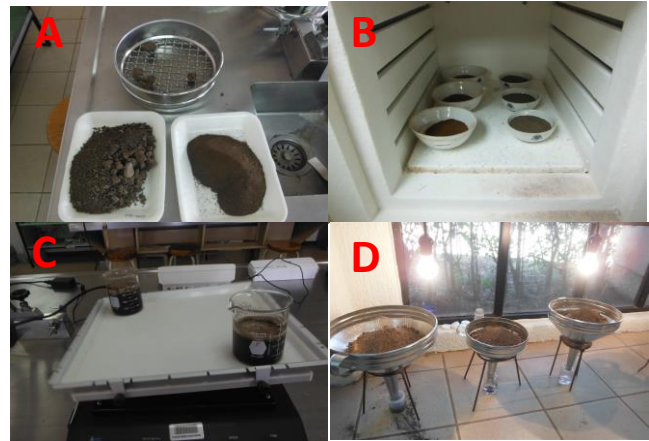
Fig. 2. A. Análisis de tamaño fragmentos. B. Muestras en mufla para calcinado de m.a. C. mezcla de suelo con agua destilada. D. sistema embudos de Berlese-Tullgren.
