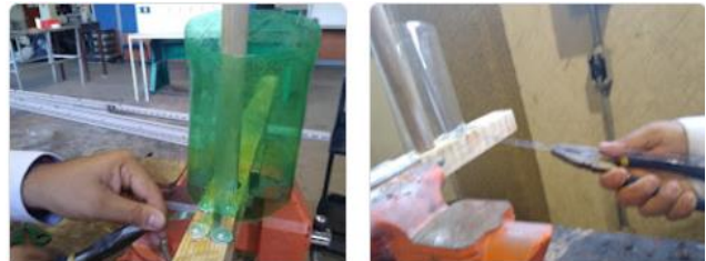
Fig. 3. Corte de listones de 0.60mm y 0.70mm de PET
