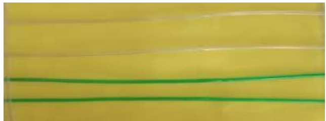
Fig. 4. Corte de listones de 1.75mm y 1.82mm de PET
