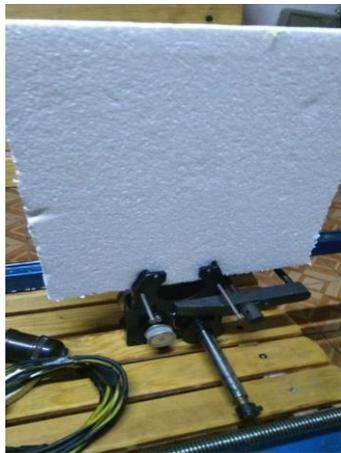
Fig. 6 Prensa sujetadora de foam
