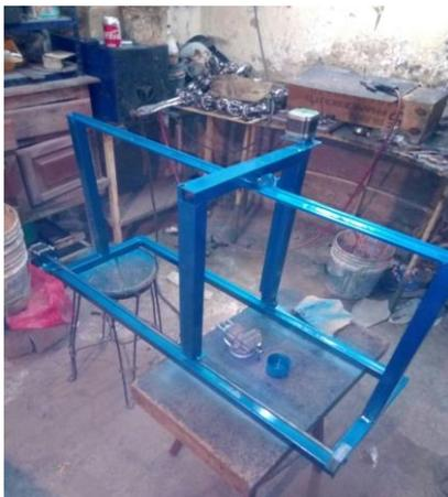
Fig.2. Estructura de PTR de 3/4 calibre 18
